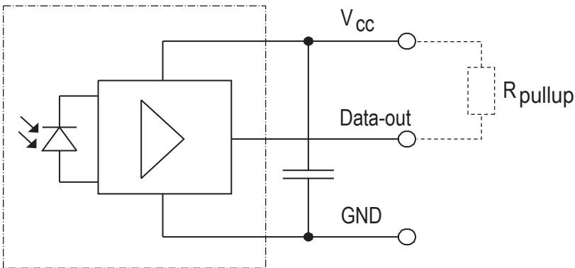
**Figure 1. Block Diagram**
