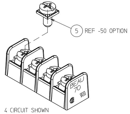
SCREW ASSEMBLY DETAIL FOR -47-50 OPTION SCALE 2:1
