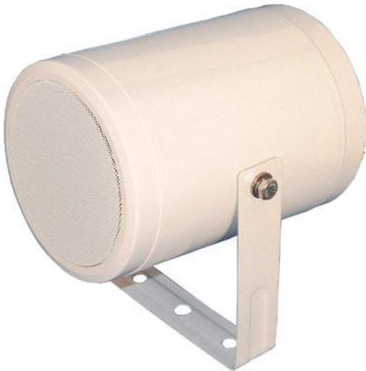
**Projektionslautsprecher** mit zylindrischem Kunststoffgehäuse (ABS) und beweglichem Montagebügel. Wand- und Deckenmontage möglich. Hohe Sprachverständlichkeit. Bestückt mit einem Breitbandlautsprecher, 100-V-Übertrager, Keramikkleb- und Thermosicherung. Entspricht den niederländischen (NEN 2575) und britischen (BS 5839) Vorschriften für Alarmsysteme. Vorbereitet zur Einführung von feuerfesten Kabeln über eine M16-Kabelverschraubung.
