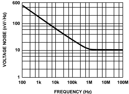
FIGURE 18. INPUT VOLTAGE NOISE SPECTRAL DENSITY vs FREQUENCY
