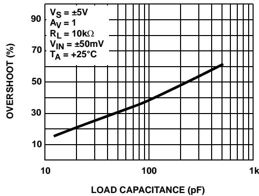
FIGURE 21. SMALL SIGNAL OVERSHOOT vs LOAD CAPACITANCE
