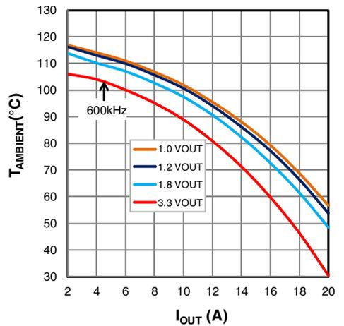
Figure 22: Maximum  $T_{AMBIENT}$  vs  $I_{OUT}$ ,  $V_{IN}=12\text{V}$
