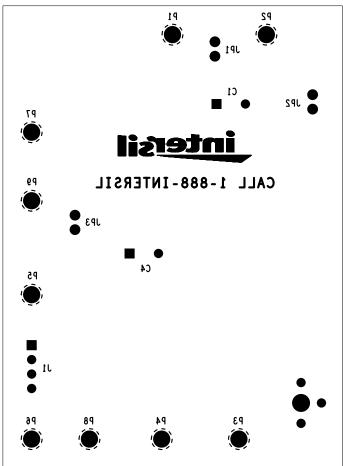
FIGURE 26. BOTTOM LAYER SOLDER SIDE
