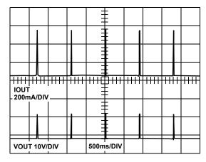
FIGURE 9. OVERCURRENT HICCUP MODE
