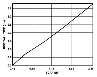
FIGURE 14. TCAP CAPACITOR VALUE vs OUTPUT TRANSITION TIME
