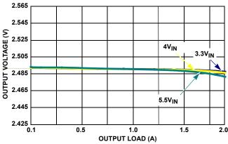
FIGURE 18. V<sub>OUT2</sub> = 2.5V REGULATION vs LOAD
