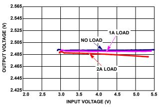
FIGURE 19. V<sub>OUT2</sub> = 2.5V REGULATION vs VIN
