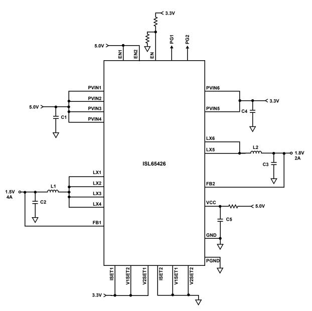
FIGURE 2. TYPICAL APPLICATION FOR 4A:2A CONFIGURATION
