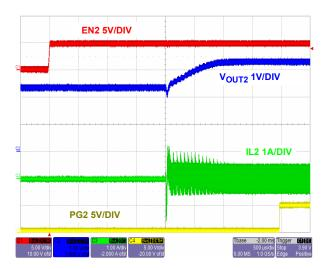
FIGURE 27. START-UP V<sub>OUT2</sub> = 3.3V (UNDER PRE-BIASED)
