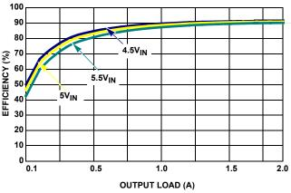
FIGURE 9. V<sub>OUT2</sub> = 3.3V EFFICIENCY vs LOAD
