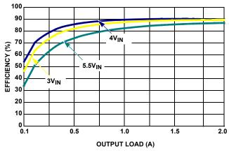
FIGURE 8. V<sub>OUT2</sub> = 2.5V EFFICIENCY VS LOAD
