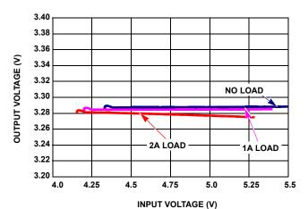
FIGURE 21. V<sub>OUT2</sub> = 3.3V REGULATION vs VIN
