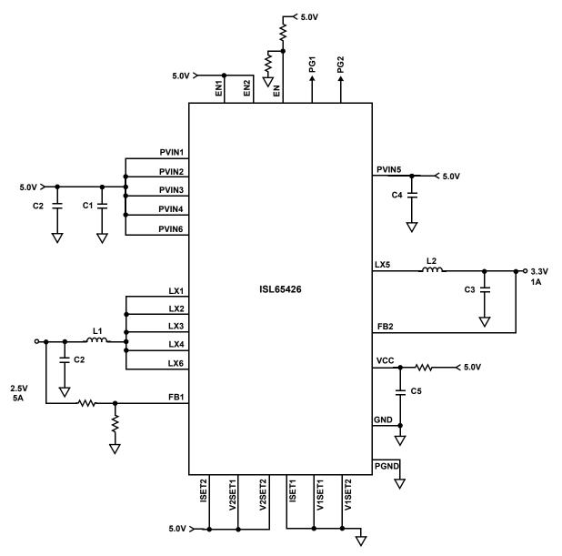
FIGURE 3. TYPICAL APPLICATION FOR 5A:1A CONFIGURATION
