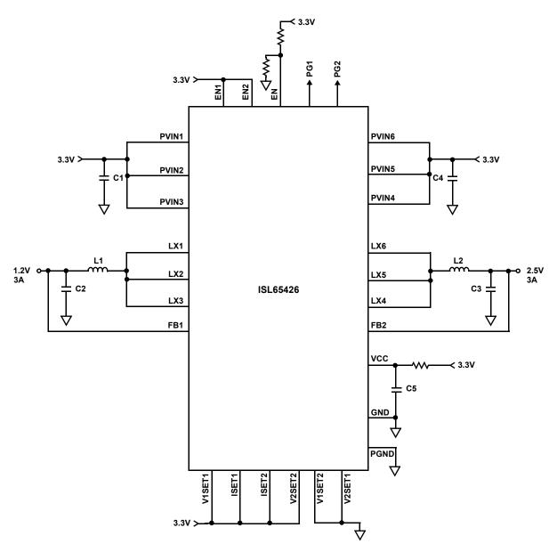
FIGURE 1. TYPICAL APPLICATION FOR 3A:3A CONFIGURATION
