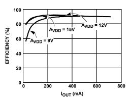
FIGURE 2. V<sub>BOOST</sub> EFFICIENCY AT V<sub>IN</sub> = 5V (PI-MODE)
