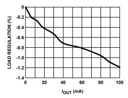
FIGURE 12. V<sub>OFF</sub> LOAD REGULATION
