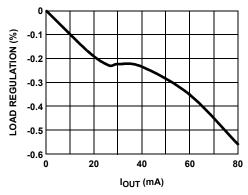
FIGURE 11. V<sub>ON</sub> LOAD REGULATION
