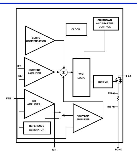
FIGURE 21. BLOCK DIAGRAM OF THE BOOST REGULATOR
