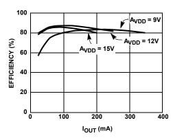
FIGURE 1. V<sub>BOOST</sub> EFFICIENCY AT V<sub>IN</sub> = 3V (PI-MODE)
