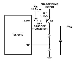
FIGURE 26. CASCODE NPN TRANSISTOR CONFIGURATION FOR HIGH CHARGE PUMP OUTPUT VOLTAGE (>36V)
