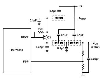
FIGURE 27. THE LINEAR REGULATOR CONTROLS ONE STAGE OF CHARGE PUMP
