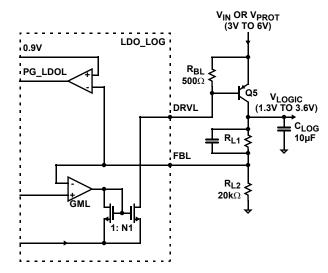
FIGURE 25. VLOGIC FUNCTIONAL BLOCK DIAGRAM
