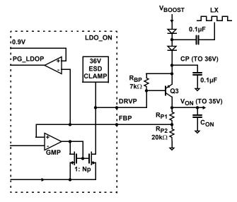
FIGURE 23. VON FUNCTIONAL BLOCK DIAGRAM
