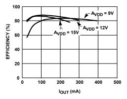
FIGURE 3. V<sub>BOOST</sub> EFFICIENCY AT V<sub>IN</sub> = 3V (P-MODE)
