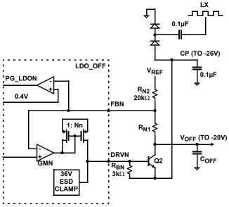
FIGURE 24.  $V_{\mbox{OFF}}$  FUNCTIONAL BLOCK DIAGRAM
