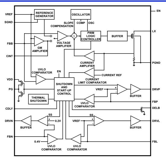
FIGURE 20. BLOCK DIAGRAM
