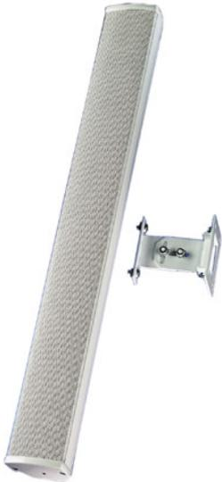
**Sehr schlanke Lautsprecherzeile** in 100-V-Technik, bestückt mit acht 5-cm-Lautsprechern. Wandbefestigung mit Montagewinkeln an den Stirnseiten oder mit optionaler Gelenkhalterung. Nach Montage in alle Richtungen schwenkbar. Weiß lackiertes Aluminiumgehäuse und Abdeckgitter (RAL 9010).
