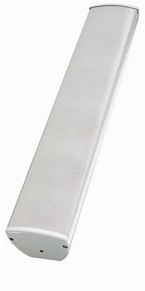
**Schlanke Lautsprecherzeile** in 100-V-Technik, bestückt mit vier 8-cm-Lautsprechern und einem Hochtöner. Wandbefestigung mit Montagewinkeln an den Stirnseiten oder mit optionaler Gelenkhalterung. Nach Montage in alle Richtungen schwenkbar. Weiß lackiertes Aluminiumgehäuse und Abdeckgitter (RAL 9010).
