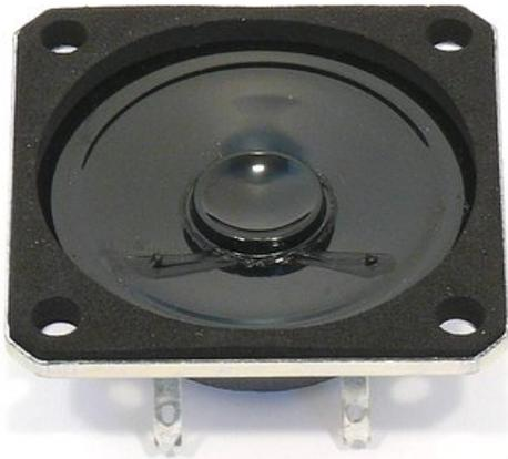
**5 cm (2") Kleinlautsprecher** mit Kunststoff-membran, quadratischem Metallkorb mit 4 Montagelöchern und Schaumstoffdichtung. Flachstecker (2,8 x 0,5 mm). Geringe Baugröße, deshalb geeignet zur Signalausgabe in Geräten oder Anlagen, in denen wenig Platz zur Verfügung steht.
