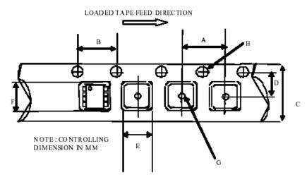
CARRIER TAPE DIMENSION FOR 14SOICN
