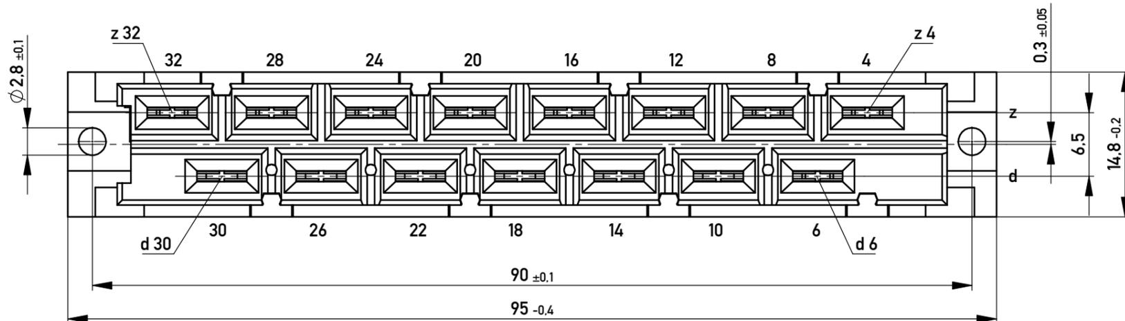
Lötanschluss  $1,2 \times 0,6$  mm / solder terminal  $1,2 \times 0,6$  mm
